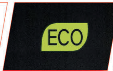
ไฟแสดงข้อมูลการขับขี่ Eco แสดงผลเมื่อขับขี่แบบประหยัด
