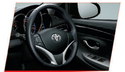
พวงมาลัยพาวเวอร์ไฟฟ้า EPS (Electric Power Steering) ควบคุมด้วยระบบไฟฟ้าโดยปรับเปลี่ยนน้ำหนักของพวงมาลัยอัตโนมัติให้เหมาะสมกับทุกสภาพความเร็ว ควบคุมง่ายและแม่นยำในทุกสภาพการขับขี่
