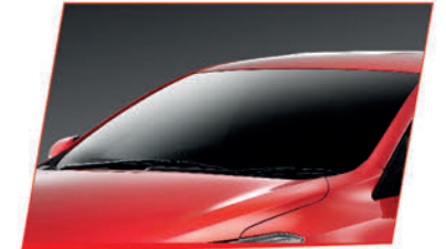
กระจกบังลมหน้าแบบ Acoustic Glass ช่วยลดเสียงรบกวนขณะขับขี่
